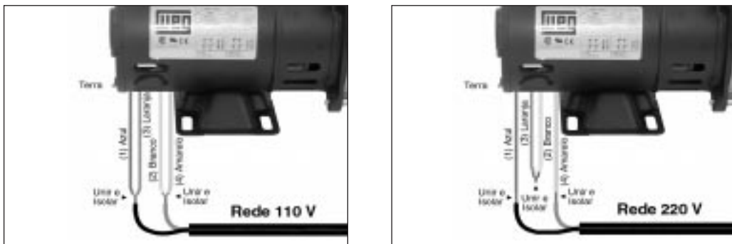
Figura 2 - Esquema de ligação motores monofásicos
